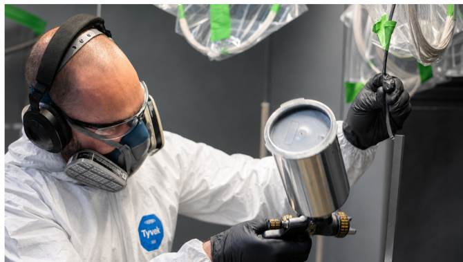
Application d'un revêtement semi-conducteur
